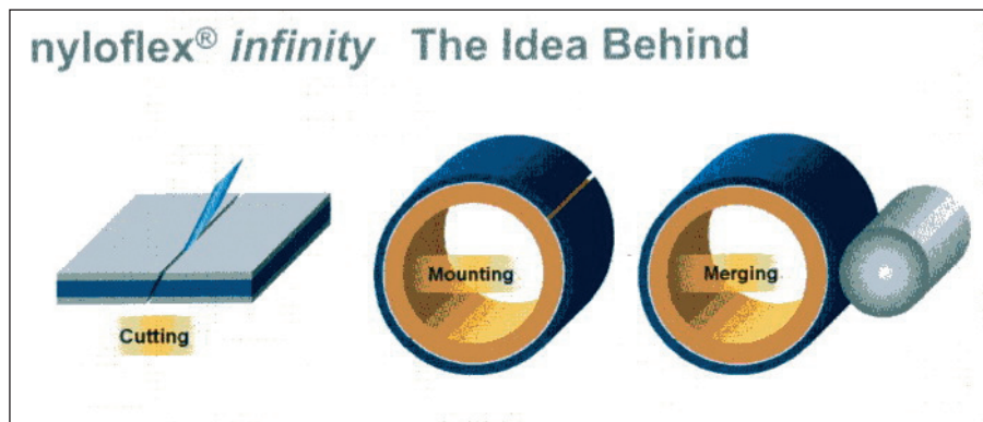
4. att.: 3 soļi apaļas sagataves iegūšanai bezgalīgai formai var tikt paveikti mazāk nekā 1 stundas laikā.
